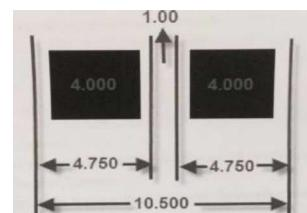
Les plaques doivent suivre le frame. Si le frame change de direction et que plus d'une plaque sont utilisées, la partie la plus proche entre les plaques doit respecter le 1 pouce d'espace minimum entre les 2 plaques. Toutes réparations doivent être déclarées aux officiels lors de l'inspection du matin et avant la course. Il est le devoir du coureur de déclarer les réparations. Toute réparation non déclarée aux
